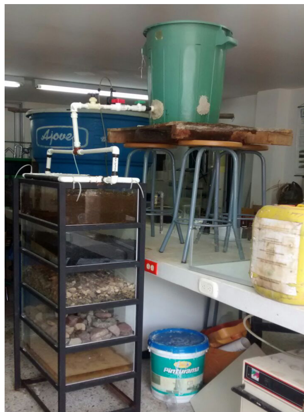
Figura 1. Montaje del lombrifiltro
