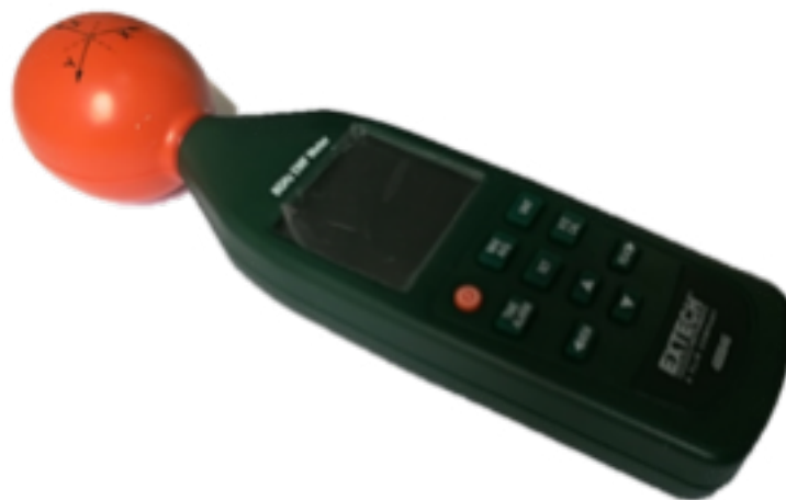
Figura 5. Equipo medidor de intensidad de RF CEM EXTECH INSTRUMENTS Modelo 480846
