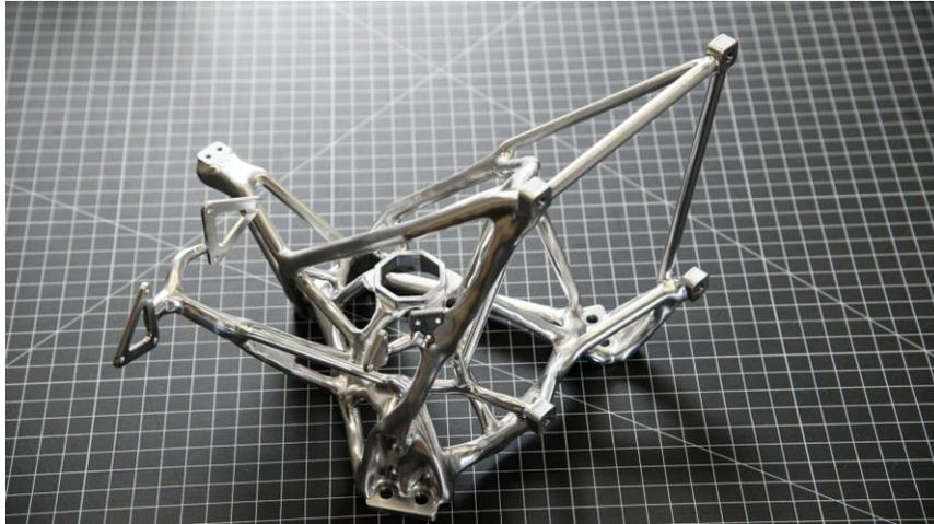
**Figura 1.** Estrutura projetada por algoritmo genético (Henry Dennis/Nasa)
