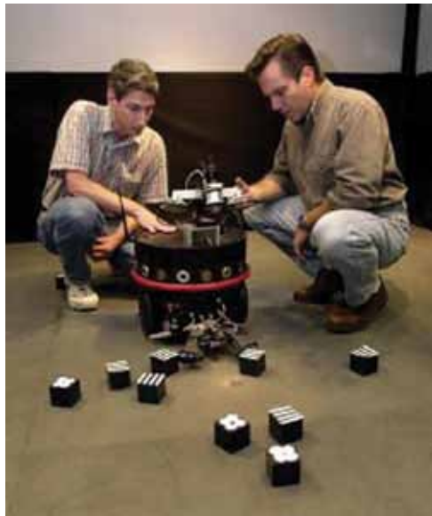
Figura 3. NOMAD (Neurally Organized Mobile Device). Los obstáculos representados aquí por cubos negros en cuya superficie se detectan parámetros visuales de diferentes formas pintadas en color blanco, como rayas, rombos y círculos, permiten al aparato hacer una selección para facilitar el desplazamiento por la habitación (tomado de Edelman, 2006: 132).
