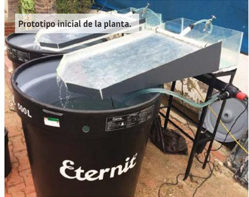
En un segundo momento, se realiza el **análisis y filtrado del agua**. Allí, los organismos que tengan una **medida superior a las cincuenta micras** (0,05 milímetros) **son eliminados con barreras físicas**. Posteriormente, el líquido **se lleva al reactor para iniciar la eliminación** mediante la metodología fisicoquímica.
